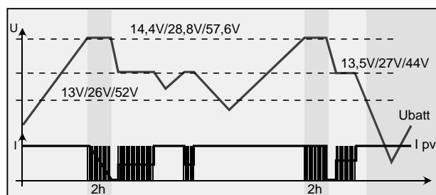
**HINWEIS:** Da der im AJ integrierte Solarladeregler eine PWM-Regelung hat, dürfen nur Solarmodule mit 36 oder 72 Zellen angeschlossen werden (12V oder 24V Off-Grid Module). Für alle anderen Arten von Solarmodulen wird ein MPPT-Solarladeregler benötigt (z.B. VarioTrack oder VarioString).
