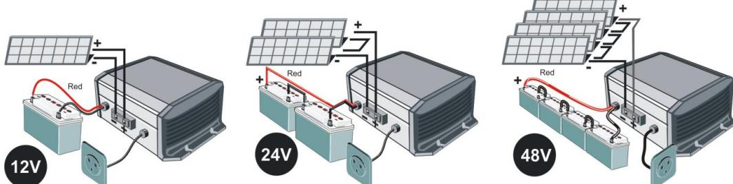
Kontrollieren Sie, dass die Anschlüsse gut festgeschraubt sind.
