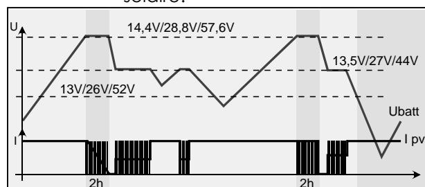
**NOTE : Comme le régulateur solaire intégré à l'AJ est de type PWM, il n'est autorisé de brancher que des panneaux 36 ou 72 cellules (12V ou 24V respectivement). Tout autre type de panneaux nécessitera un régulateur MPPT (p.ex VarioTrack ou VarioString).**
